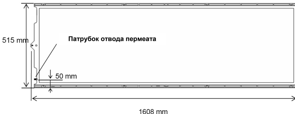
Рис. III-1. Внешний вид и габаритные размеры мембранного элемента (TSP-50150)
